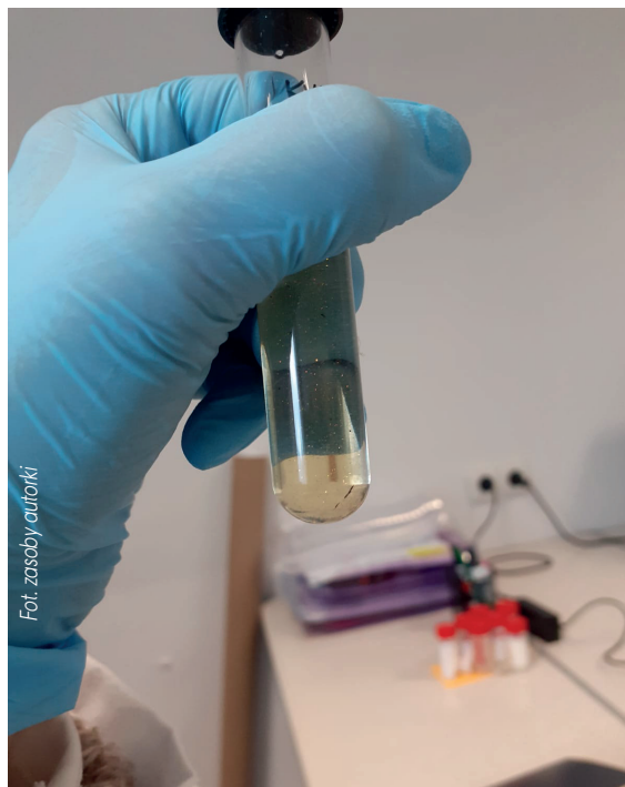
FOT. 3 Zanieczyszczenie produktu w postaci czarnych drobinek
